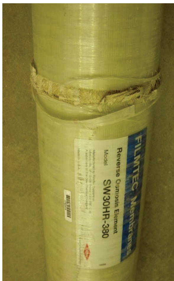
9-9 膜表面缠绕玻璃钢高压差破裂
