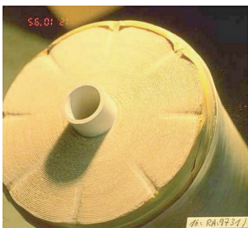
图 9-8 膜元件上抗应力器被拉掉了
